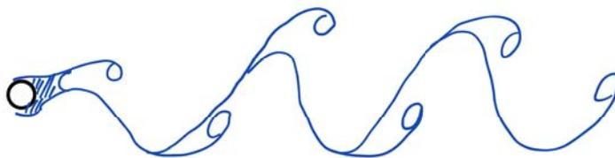
Serie di Von Kármán: distacco regolare di strutture vorticosi a valle del cilindro.
