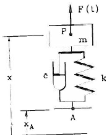
Il termine smorzatore viscoso viene generalmente usato per indicare un dispositivo che introduce nel sistema una forza proporzionale alla velocità e con direzione opposta a quest'ultima.
