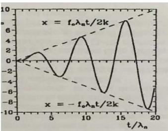
In questa figura abbiamo la risposta ad una eccitazione armonica con frequenza uguale alla frequenza propria del sistema. Osserviamo come l'ampiezza della risposta aumenta linearmente nel tempo ed essa è massima quando i due termini armonici raggiungono contemporaneamente il valore massimo, uno negativo e l'altro negativo.
