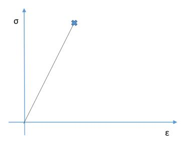
Come si vede dal grafico una volta raggiunto i limite elastico si ha la rottura del materiale. La deformazione elastica vale per tutti i tipi dei materiali, ma nei metalli, a differenza degli altri, non si ha una rottura immediata ma una volta superato il limite elastico si entra nel campo delle deformazioni plastiche. Pertanto l'energia non verrà utilizzata, come nel caso dei materiali fragili per creare nuove superfici (rottura), ma per deformare il materiale.
