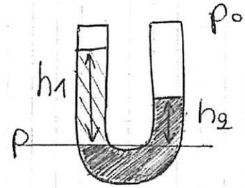
2 liquidi non miscibili raggiungono altezze inversamente proporzionali alla loro densità  $\rho$ ! Utile x determinare la densità di un fluido!
