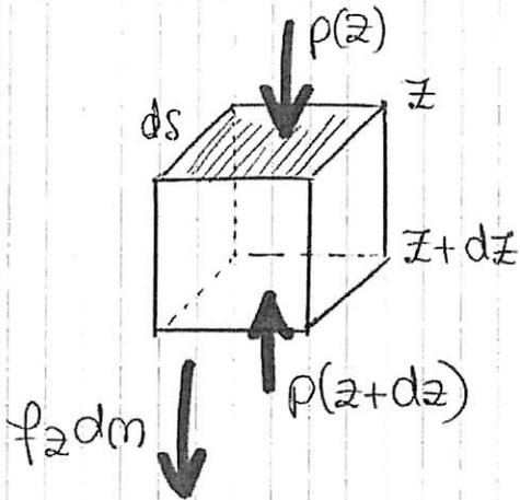
elemento di fluido cubico, di volume finito
